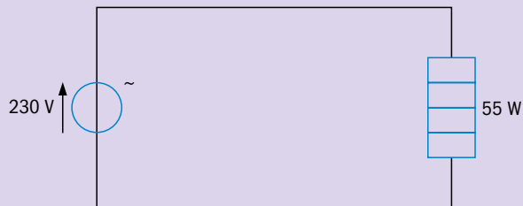
FIGUUR 1.22 Soldeerbout 55 W
