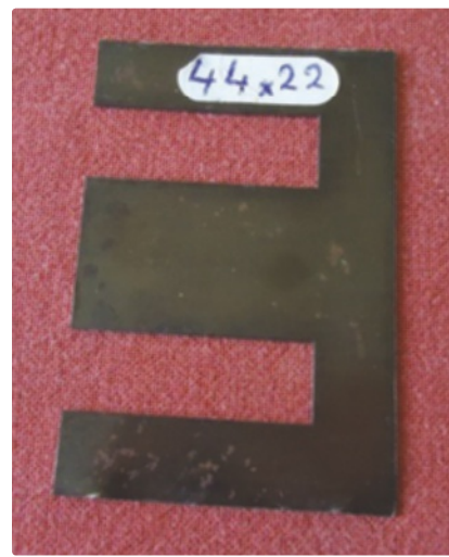
Figuur 13 Blikpakket van een transformator (Bron: bouwer.m@planet.nl/Rinus Bouwer/Tekenbureau Frans Hessels)
