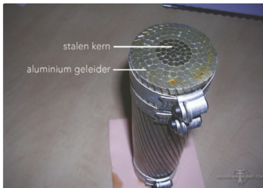
a demo van een hoogspanningskabel
