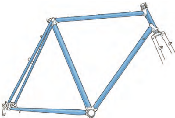
Figuur 1.1 Fietsframe met buizen in blauw en luggen in wit
