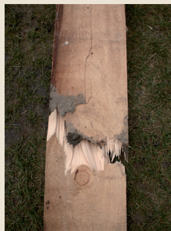
Figuur 1. Kwasten in hout. Links een ingegroeide tak in larikshout. Het linkerdeel is ontstaan terwijl de tak nog leefde en is volledig vergroeid met het omringende hout. Het rechterdeel is overgroeid nadat de tak is afgezaagd, waarbij een losse kwast ontstaan is doordat het met schors en al is ingesloten in het hout zonder daarmee te vergroeien. Vanaf de afgezaagde takstomp is naar buiten toe kwastvrij hout gegroeid. Rechts een plank die op de zwakke plek rond een kwast is gebroken. Foto's: René Klaassen.
