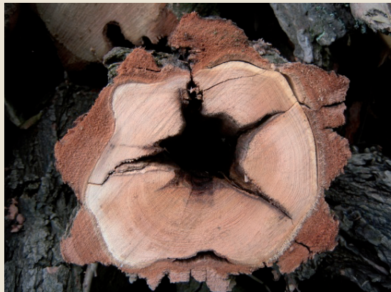
Figuur 2. Geïnfecteerde beukenstam met valse kern (boven) en rotte kern in robinia als gevolg van schimmelaantasting van het juveniele hout (onder). Foto's: René Klaassen.
