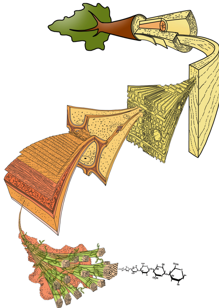
Figuur 2-7. De structuur van het hout in de boom op verschillende schaalniveaus, gaande van de basisbouwstof cellulose, via microfibrillen, celwand, houtcel, xyleem, jaarring tot uiteindelijk de boom. Naar M. Harrington, University of Canterbury.
