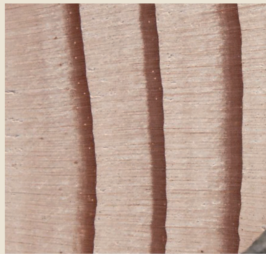
Figuur 5. Verschillen in jaarringopbouw, met een geleidelijke overgang van vroeg- naar laathout bij de fijnspar (boven) en een abrupte overgang bij de lariks (onder). Foto's: René Klaassen.
