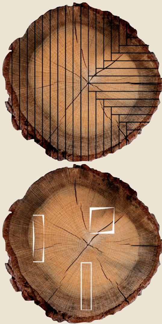
Figuur 4. Zaagmethoden voor boomstammen (boven) met rechts kwartiers gezaagde en links dosse gezaagde planken. Onderaan de wijze van krimp in gezaagd hout uit verschillende delen van de stam. Foto's: Jan den Ouden.
