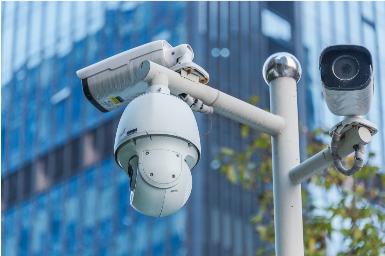
Vaste en dome camera's gecombineerd.
