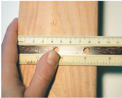
FIGUUR 1.2 Het meten van de breedte van een plank met een liniaal. De onnauwkeurigheid is circa 1 mm.
