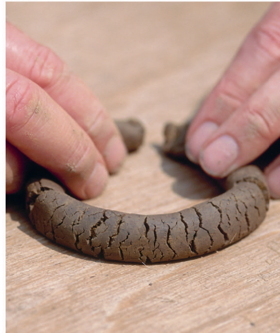
Maak een worst van je monster. Kun je die tot een ring buigen? Dan is dat een aanwijzing dat je veel klei in de grond hebt.
