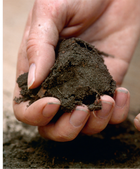
Per's de aarde samen en laat los. Druk het daarna lichtjes aan met je duim. Zandgrond verkrumelt dan.
