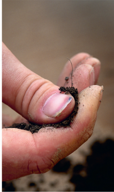
Test het zandgehalte door de aarde tussen je vingers te wrijven. Het voelt ruw aan.
