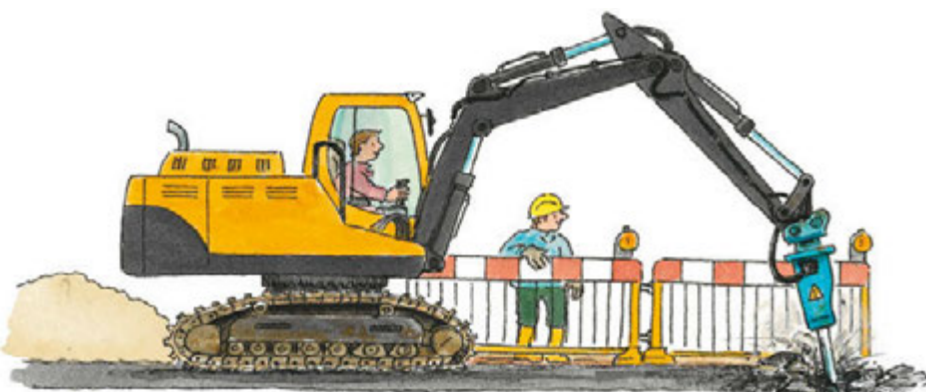
Aan deze graafmachine werd vooraan een drillboor bevestigd. Hij boort heel gemakkelijk in het wegdek en breekt het open.
