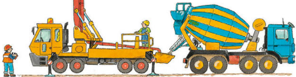
de kraanwagen met betonpomp
