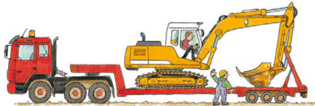
de dieplader met graafmachine op rupsbanden
