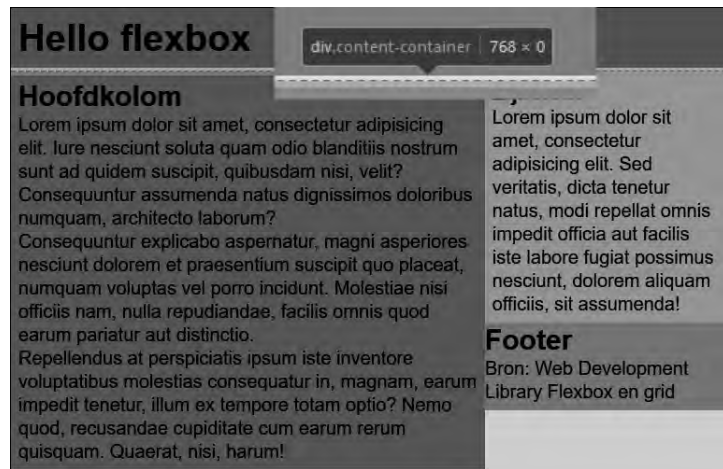
Afbeelding 1.5 Bij deze gefloate kolommen ontbreekt duidelijk een clearfix . De content-div is 0 pixels hoog.
