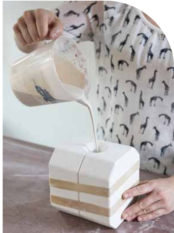
Vloeibare porselein, ook wel gietporselein genoemd, wordt in een gipsen mal gegoten. De mal wordt nadien uitgegoten waarbij een dunne laag porselein achterblijft. Na drogen wordt de mal voorzichtig verwijderd en kan het stuk verder afgewerkt worden.
