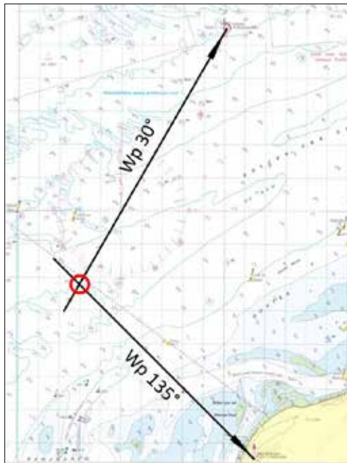
Fig. 7.4 Een kruispeiling op de vuurtoren van West-Schouwen en Goeree Lichtplatform
