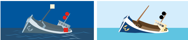
FIG. 1.28 NAVIGATIELICHTEN EN DAGTEKENEN VAN ONMANOEUVREERBARE SCHEPEN
