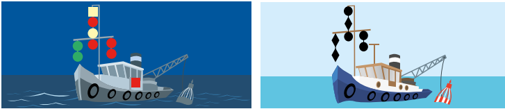
FIG. 1.27 NAVIGATIEVERLICHTING EN DAGTEKENEN VAN EEN BEPERKT MANOEUVREERBAAR SCHIP
