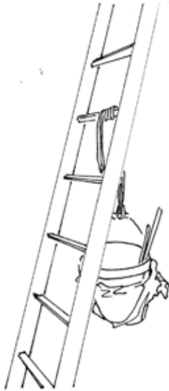
Illustratie 14. Het touw is drie-vier keer om de sport gewikkeld en de emmer met verf, roerstok en kwasten is nu binnen handbereik
