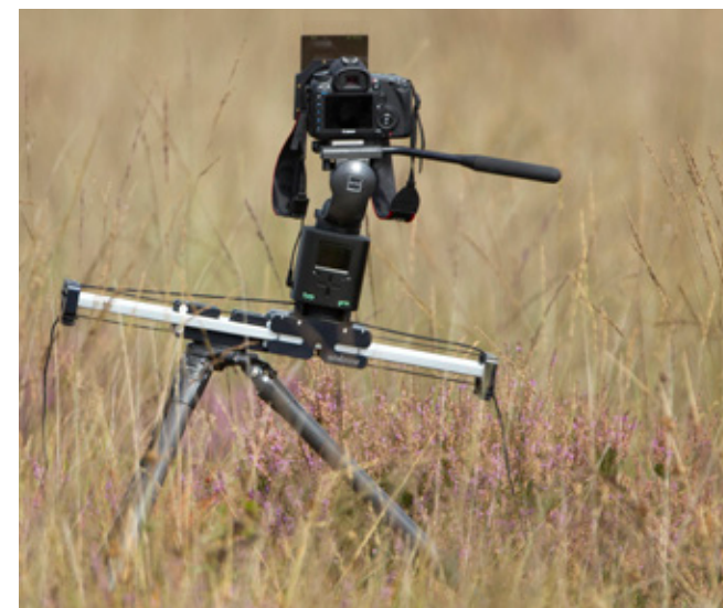
Een timelapse opstelling met een statief, slider, motion-control-unit en camera met grijsfilters op statiefkop.
