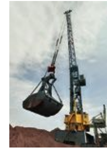
p. 39 De nemaX® grijper, inhoud 15m3. Nemag, Zierikzee. Foto Ludwig van Hooren.
