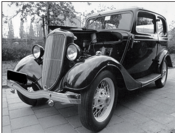
De door het moederbedrijf in Dearborn, Michigan, vormgegeven Ford Eight met een door de Britse fiscus op 8 pk gestelde viercilinder zijklepmotor en een niet van buiten af toegankelijke bagageruimte. Na prijsverlaging in 1935 werd deze gezinsauto in Engeland bekend als the hundred pound car . In Nederland raakte het tweedeurs model ingeburgerd als de 'baby'-Ford. (Auto-Vitesse Ltd., Eindhoven, zomer 1986. Foto's auteur).
