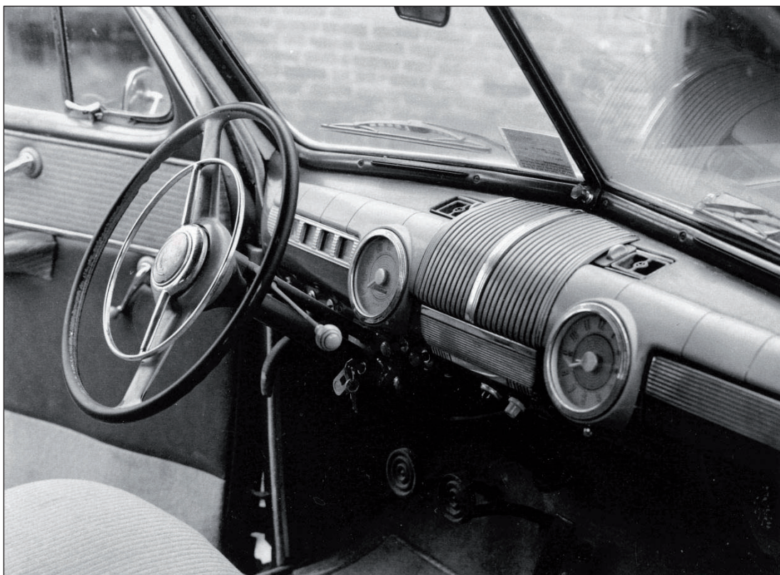
Dashboordindeling met twee asbakjes van de eerste naoorlogse Ford 'made in USA'. Tussen de ronde klokken kon een radio worden gemonteerd. De 6GA Six modelserie was leverbaar in acht carrosserie-uitvoeringen en de 69A V8 in tien. (foto auteur).
