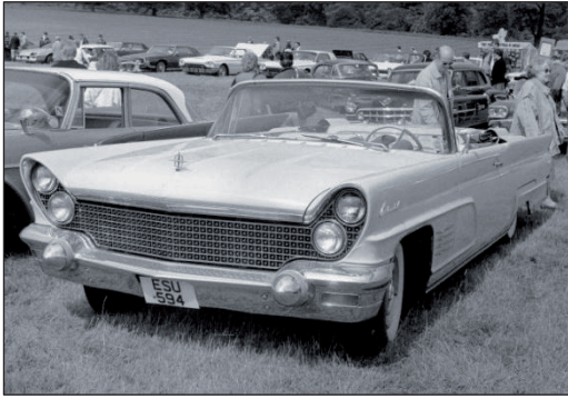
Een Lincoln Continental Mk V uit 1960, het laatste jaar dat deze cabriolet op het leveringsprogramma stond. Het ruim 2330 kilo zware tweedeurs model was uitgerust met een V8-kopklepmotor van 315 pk. Rallye of the Giants, Knebworth, juli 1988. Rechts: een Lincoln Premiere hardtop-coupe uit 1957. Oldtimerbeurs in Carlisle, Pennsylvania, september 1987. (foto's auteur).
