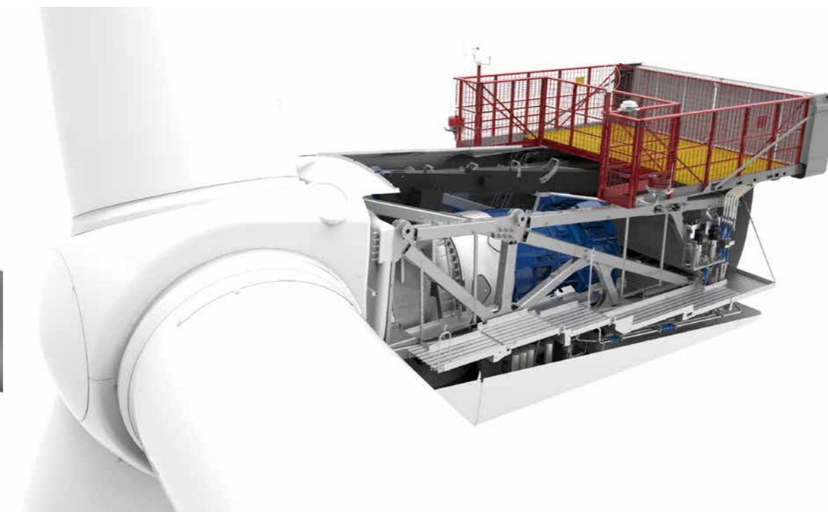
▲ De V164-turbine van Vestas met een vermogen van 10 MW.
