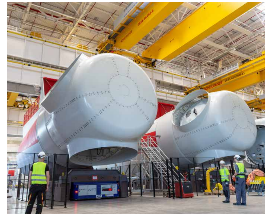
▲ Gondels, klaar voor transport naar de bouwlocatie.
