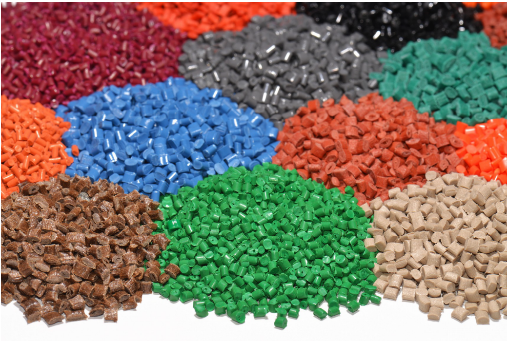
Masterbatches zijn hooggepigmenteerde kleurkorrels om plastic mee te kleuren.
