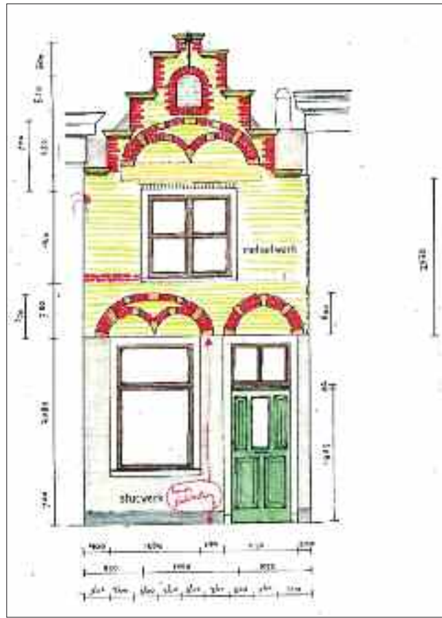
Vlamingstraat 77. Uit de aanwezigheid, of juist de afwezigheid, van accentuerende rode steentjes in het gelige metselwerk blijkt dat het is gebouwd in een rijtje met links en rechts tenminste één identiek huisje. (documentatie WFW op opmetingstekening Tak Architecten, VA, MD)
