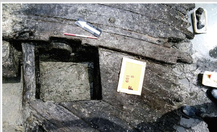
Fig. 3: Detailfoto van de laadpoort naast de voorsteven. Aan de bovenzijde bevinden zich de berghouten, waar een klein rechthoekig balkje heeft gezeten. Hier werd vermoedelijk de luikconstructie geopend.
