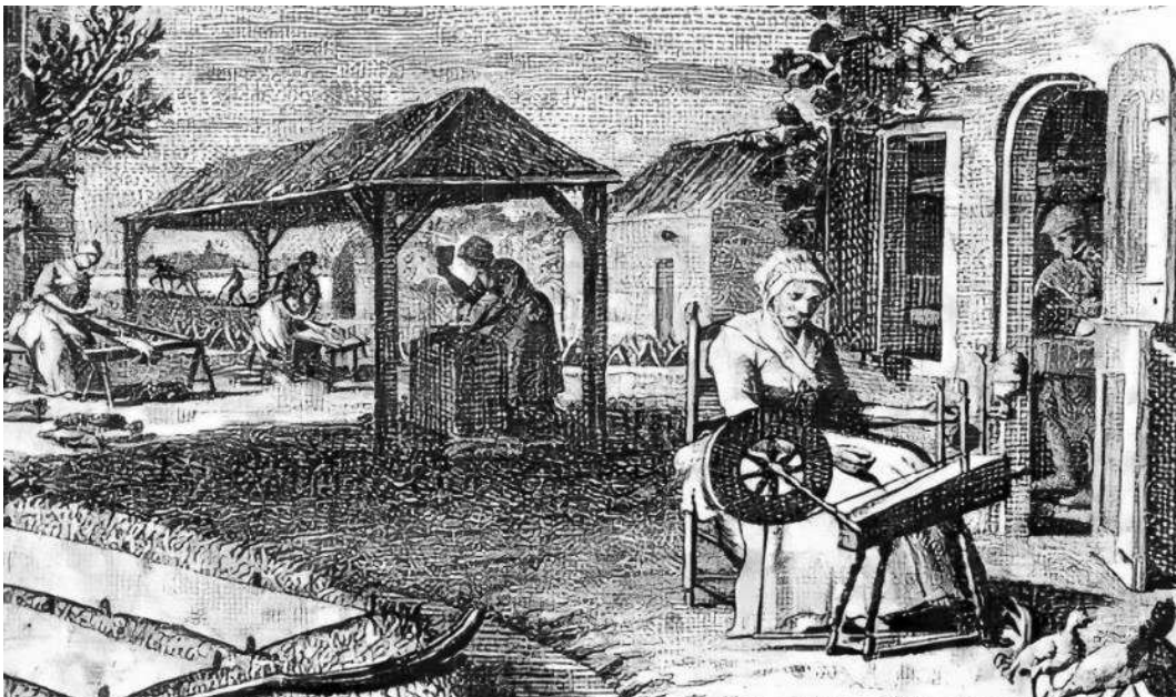
Deze prent geeft een beeld van de Vlasbewerking. V.l.n.r. kneuzen op de braak, repelen, zwingelen, spinnen en weven. Op de voorgrond liggen de banen linnen op de bleek. Prent. Historische Beroepen.
