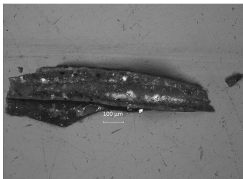
Dwarsdoorsnede van een klein verfmonster uit De Nachtwacht , genomen in 1975 van de schouder van een schutter. De onderste laag bestaat uit een grondering van onder meer rivierklei met lijnolie met gele en bruine okers, daarbovenop bevinden zich zes afzonderlijke verflagen met onder meer azurietblauw, een zwart pigment, loodwit, rood vermiljoen en organisch rood. Hierop een weinig vernis en vuil. De lagen zijn in de loop van de tijd enigszins nagedonkerd. (Foto: Muriel Geldof, RCE.)
