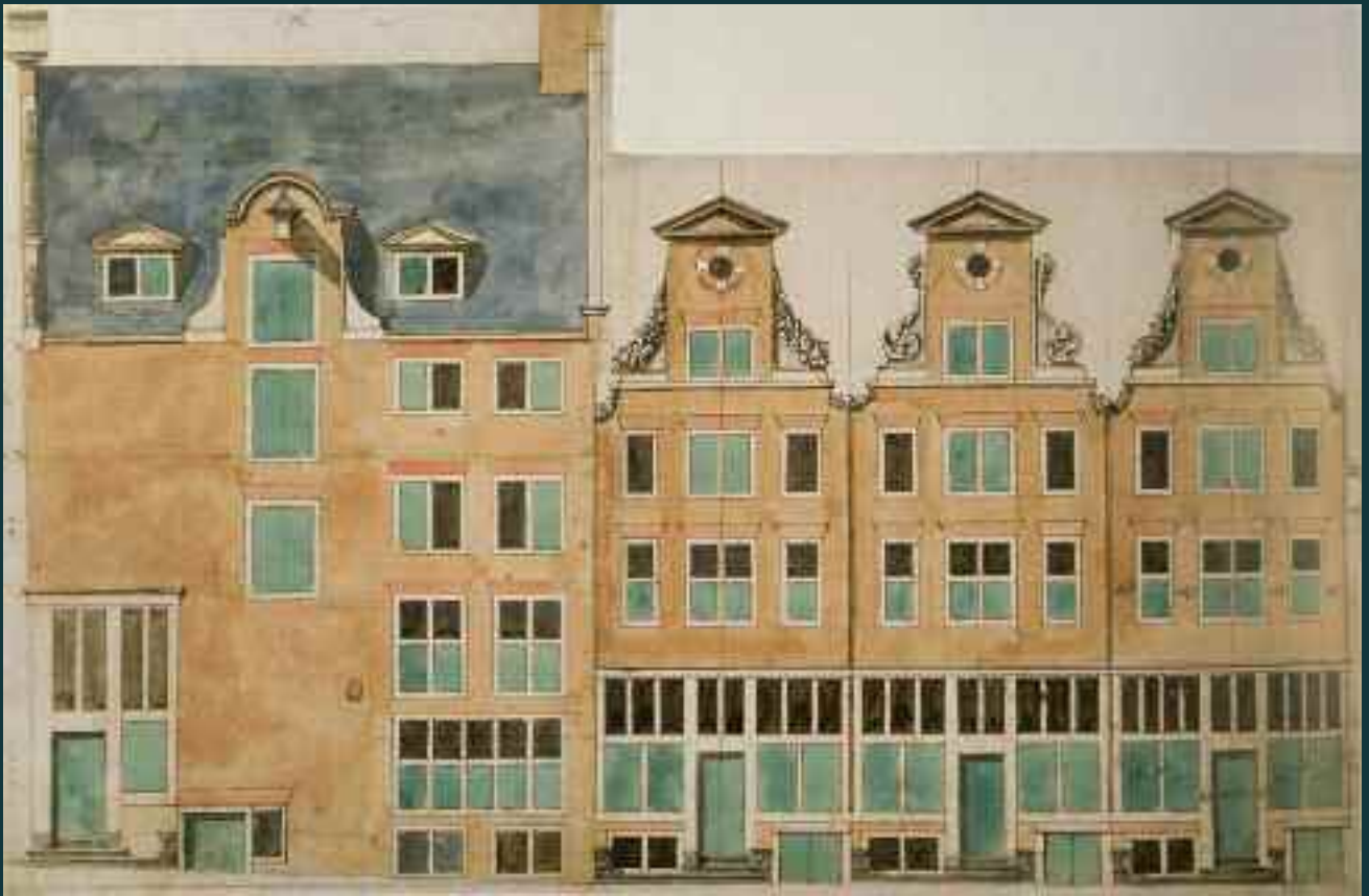
29 Amsterdam, Sint Luciensteeg. Gevelrij met houten winkelpuien. Ontwerptekening uit 1651 van Philips Vingboons. Collectie Stadsarchief Amsterdam.
