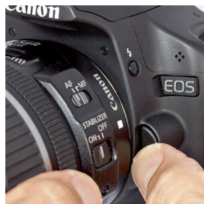
Houd deze knop ingedrukt om de lens te kunnen verwijderen van het camerahuis.
