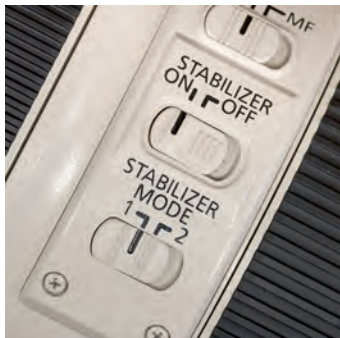
De twee schuifjes voor beeldstabilisatie op een Canon-lens uit de professionele L-serie.
