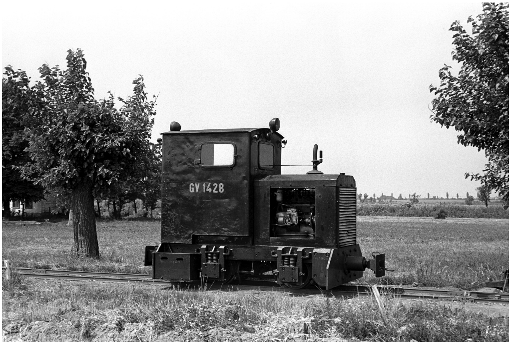
Mit den verstaatlichten Feldbahnen übernahm die GVI auch viele schwache Motorlokomotiven, wie GV 1428 für 600 mm Spurweite. O&K lieferte diesen Werkstyp MD-2 seit 1935 an verschiedenen Werks- und Feldbahnen. Das Führerhaus wurde erst später angebaut. Szigetvár, 22. Juni 1962. Foto Harald Navé.
