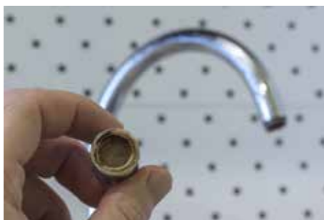
Figuur 1.7 Verstopte mousseur van een kraan.
