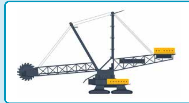
Graafwielbagger: graaft gesteente af met een lange arm met daaraan een draaiend wiel met messen.
