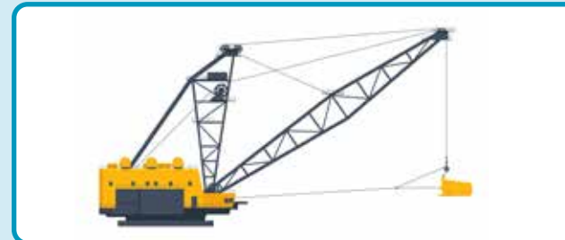
Dragline: heeft een grijper aan kabels. Zo kan de dragline makkelijk graven op een lager gelegen plek.
