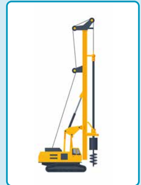
Grondboor: boort gaten in gesteente om er explosieven in te plaatsen. Sommige boren gaan tot meer dan 20 meter diep.
