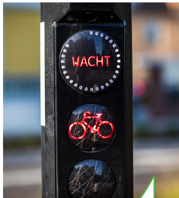
Steeds vaker zie je bij verkeerslichten voor fietsers een afteller. De puntjes laten zien hoe lang je nog moet wachten voordat het licht op groen springt.
