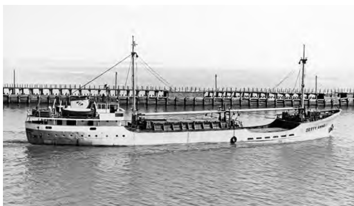
Rechtsonder: Bij de werf wordt het schip, gebouwd onder klasse + 100 A 1 van Lloyd's Register en onder toezicht van de Scheepvaartinspectie, volledig onder handen genomen. Niet duidelijk is wanneer dat precies plaatsvond. De 'Betty Anne-S' was uitgerust met de modernste navigatiemiddelen, Mac-Gregor-stalen rolluiken, mechanische ventilatie, een met olie gestookte centrale verwarming en koud- en warm stromend water. De gehele inrichting en betimmering van de hutten en salon zijn zoals op de 'Gerry-S' verzorgd door meubelfabriek J. de Nijs uit Rotterdam. Foto R. Kleyn.
