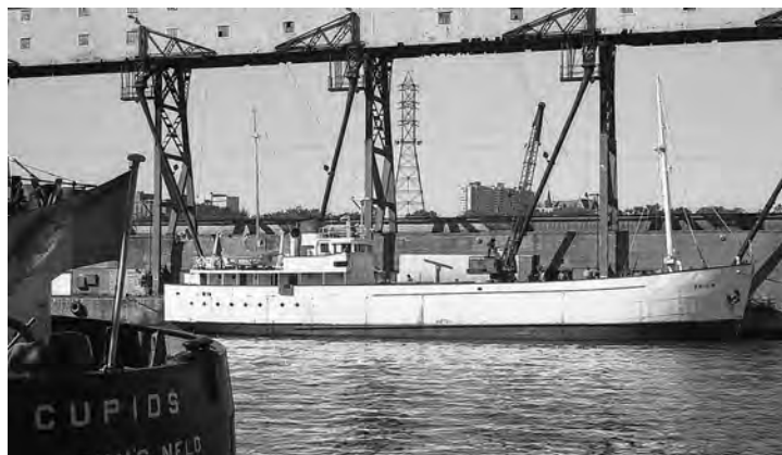
De 'Maystar' als 'Brion' op 15 september 1969 afgemeerd aan pier 24 in Halifax, Nova Scotia. De open reling aan dek is dichtgemaakt en doorgetrokken van gangboord tot aan de bak. Foto Mac Mackay.
