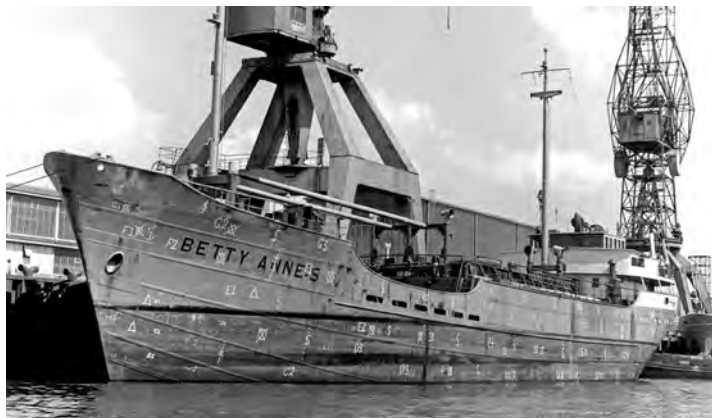
Rechtsonder: Bij de werf wordt het schip, gebouwd onder klasse + 100 A 1 van Lloyd's Register en onder toezicht van de Scheepvaartinspectie, volledig onder handen genomen. Niet duidelijk is wanneer dat precies plaatsvond. De 'Betty Anne-S' was uitgerust met de modernste navigatiemiddelen, Mac-Gregor-stalen rolluiken, mechanische ventilatie, een met olie gestookte centrale verwarming en koud- en warm stromend water. De gehele inrichting en betimmering van de hutten en salon zijn zoals op de 'Gerry-S' verzorgd door meubelfabriek J. de Nijs uit Rotterdam. Foto R. Kleyn.
