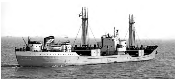
Een van de weinige foto's genomen van het achterschip. De 'Pieter-S' had twee 30-persoons-reddingsboten, waarvan één motorboot. De davits waren van het Schatpatent. De werkboot staat op de accommodatie van de machinisten. Foto Donald Macfie.
