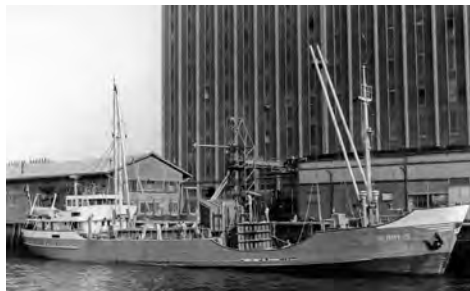
De 'Gerry-S' laadt op 16 juli 1964 graan bij de in 1915 opgerichte N.V. MEelfabrieken der NEDerlandsche BAKkerij (Meneba) in de Maashaven in Rotterdam. De opstelling van de geopende Mac-Gregor luiken zijn goed te zien. Collectie auteur.
