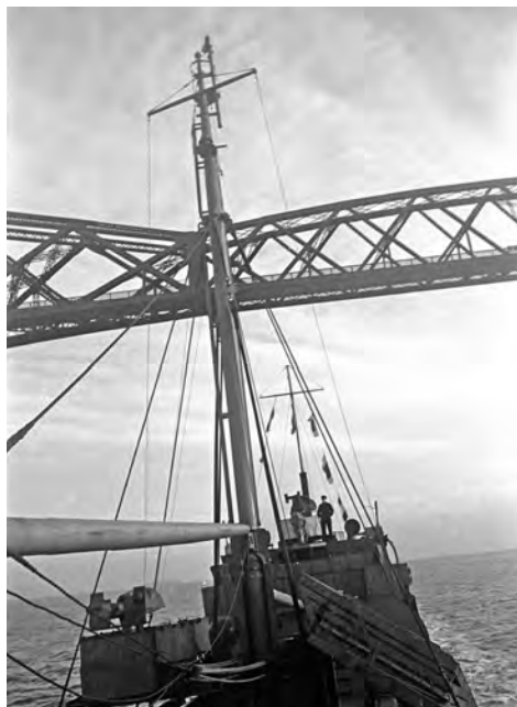
Links: De 'Algarve' passeert de Forth Bridge. In de brug is meer dan tienmaal zoveel staal gebruikt als nodig was voor de bouw van de Eiffeltoren en wordt gezien als het grootste bouwwerk van de 19e eeuw. De drie cantileverconstructies zijn 110 meter hoog. De langste overspanning is twee keer 521,30 meter. Sinds 2015 staat de Forth Bridge op de Werelderfgoedlijst van de Unesco. Firth of Forth december 1942. Fotocollectie Anefo/RVD.CCO.
