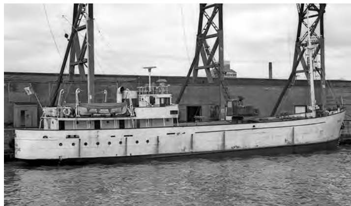
De coaster is enigszins verbouwd. De middenmast is weggehaald en vervangen door een mast op het voordek. Op de plek van de voormalige middenmast staat een oude dragline waar de rupsbanden van zijn verwijderd en geplaatst op een onderstel waarop de kraan kan draaien. Het zou ook nog een oude kraanwagen geweest kunnen zijn. De opname is van 7 april 1970 aan pier 24 in Halifax. Foto Mac Mackay.
