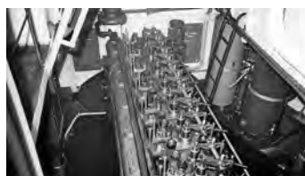
De 8 cil. Werkspoor dieselmotor van 500 pk gaf tijdens de technische proefvaart een snelheid van tussen de 11 en 12 knopen. De gemiddelde snelheid van de 'R.P.S.' die de Werkspoor motor leverde was 10 knopen. Maar veel hield af van de weersomstandigheden tijdens de vaart. Collectie auteur.
