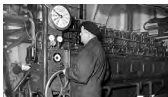
De 8 cil. Werkspoor dieselmotor van 500 pk gaf tijdens de technische proefvaart een snelheid van tussen de 11 en 12 knopen. De gemiddelde snelheid van de 'R.P.S.' die de Werkspoor motor leverde was 10 knopen. Maar veel hield af van de weersomstandigheden tijdens de vaart. Collectie auteur.
