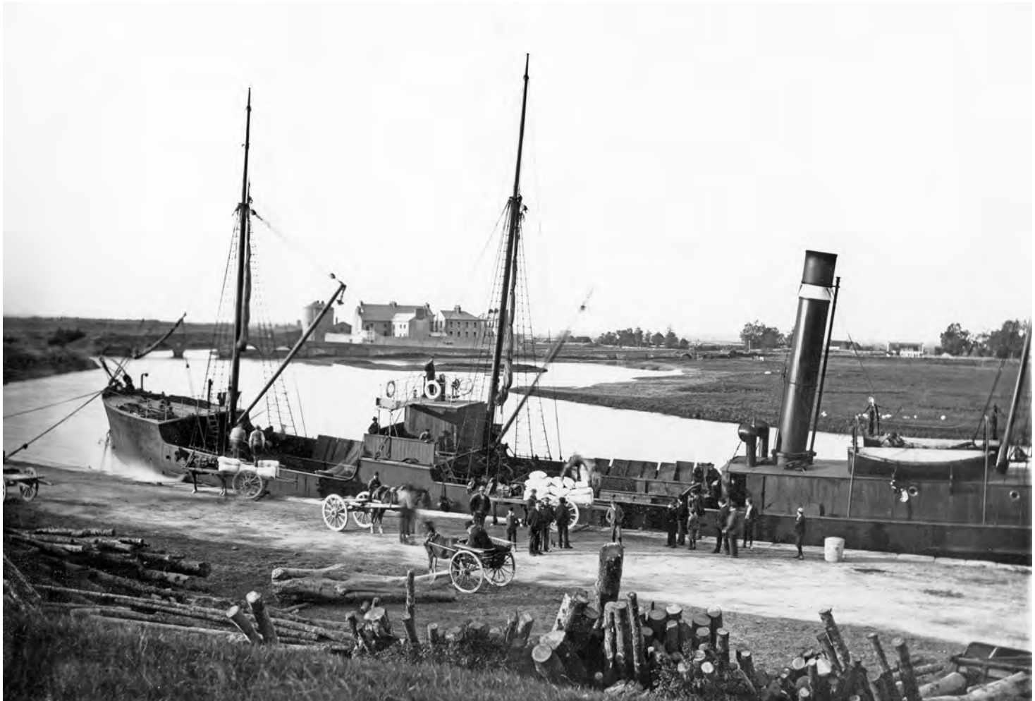
Een iconische foto van het in 1894 in Workington (Cumbria) gebouwde stoomschip 'Queen's Channel' met een lengte van 46,63 meter, breedte van 7,10 meter en een diepgang van 2,74 meter. Het 370 registerton metende schip was eigendom van Queen's Channel SS. Co. Ltd. (J. Edwards & Co.), 17 Water Street in Liverpool. In de tijd dat foto werd genomen aan de kade van Clarecastle rond 1900 liep het zeiltijdperk zo'n beetje op zijn einde en was het stoomtijdperk meer en meer in opkomst. Toch zien we voor alle zekerheid nog zeilen opgerold aan de masten. Op de achtergrond de fraaie in 1780 ontworpen en door John Semple gebouwde stenen vijf-bogige brug die in 1971 werd afgebroken om plaats te maken voor een betonnen brug die beter geschikt was voor het doorgaande verkeer. Ook zien we het O'Brien kasteel dat dateert uit de vijftiende/zestiende eeuw en een kazerne uit 1748-1751. Het strategische gelegen fort werd veroverd door Cromwellians in 1651 en door Williamites in 1691. Het garnizoen in Clarecastle ontstond in het midden van de jaren 1600 en van 1691 tot 1881 was het, het belangrijkste Britse legergarnizoen in Clare. De kazerne deed dienst tot 1921. Foto William Lawrence, Lawrence Collection, NLI, via Eric Shaw.
