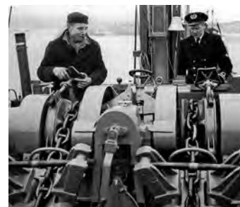
Ankerproeven, voor de kust op de Noordzee, horen altijd bij een technische proefvaart.
