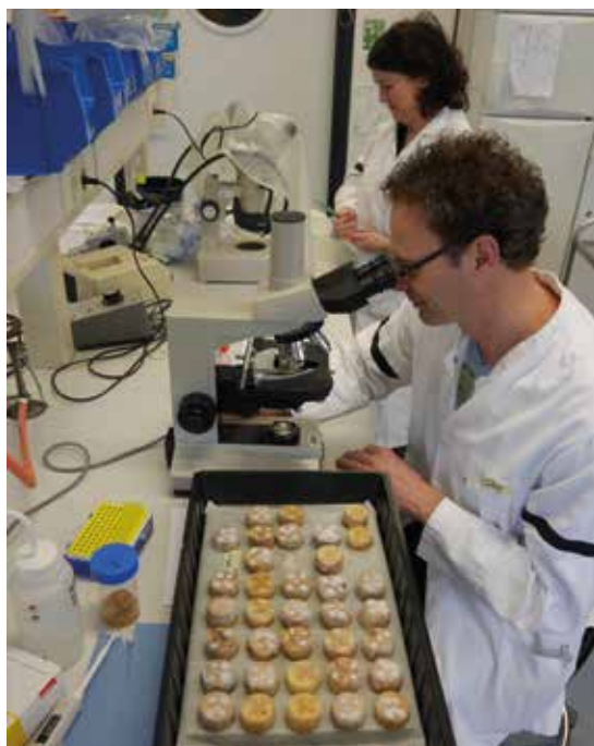
↑ Een ziekte-toets voor resistentie tegen Phytophthora in aardappel op het instituut Wageningen Plant Research. Aardappelschijfjes worden geïnfecteerd met de schimmel en na verloop van tijd beoordeeld op de mate van aantasting.
