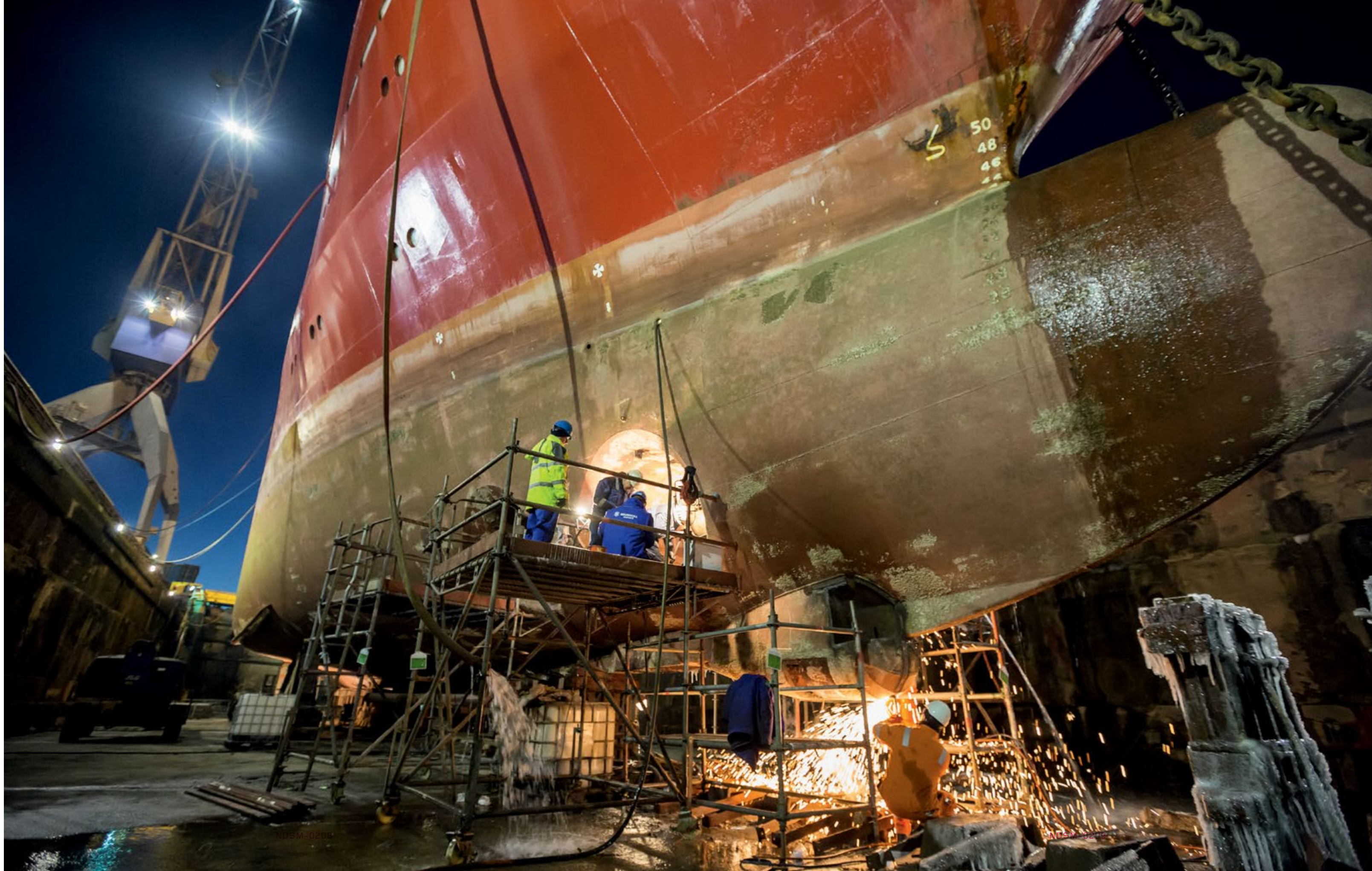
2017 In de vrieskou wordt gewerkt aan een research & survey ship (onderzoeks- en meetship) in dok 2. De mannen op de steiger houden zich bezig met het plaatsen van een nieuwe boegschroef. Onder hen branden ijzerwerkers de sonar van het schip los. In the freezing cold, work is being done on a research & survey ship in dock 2. The men on the jetty are engaged in placing a new bow thruster. Below, iron workers are burning loose the sonar of the ship.
