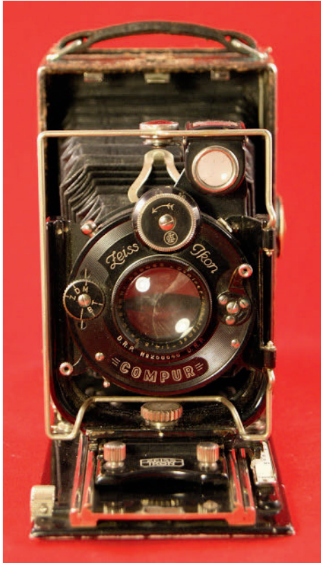
Zeiss fotoestel dat werkte met 9 x 12 centimeter glasnegatieven, circa 1930.
