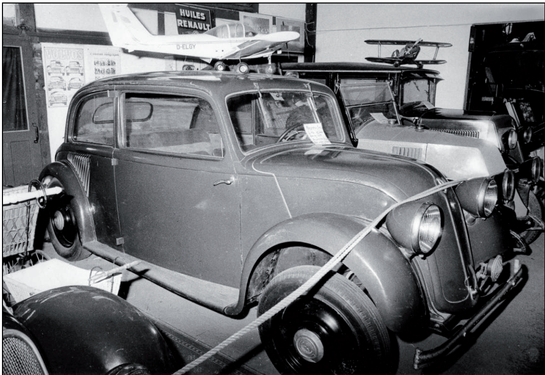
Achterwielaangedreven Mercedes-Benz type 130 (W 23) uit 1935 met een staartgeplaatste 1308 cc viercilindermotor van 26 pk. Eigen gewicht 980 kilo. Topsnelheid 92 kilometer per uur bij een verbruik van 10 liter per 100 kilometer. Met 65 procent van het wagen gewicht op de achteras was deze auto zeer staartlastig. (Fahrzeugmuseum Reichert, Marxzell, Baden-Württemberg. Foto auteur).
