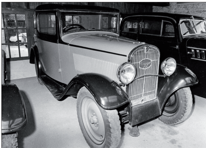
Rosengart Six uit 1932 met een van Austin afkomstige 1100 cc zescilindermotor. Onder: Rosengart Supertraction 11CV uit 1939 met een 1649 cc viercilinder zijklepmotor en voorwielaandrijving naar een patent van Citroën. (Foto's auteur).
