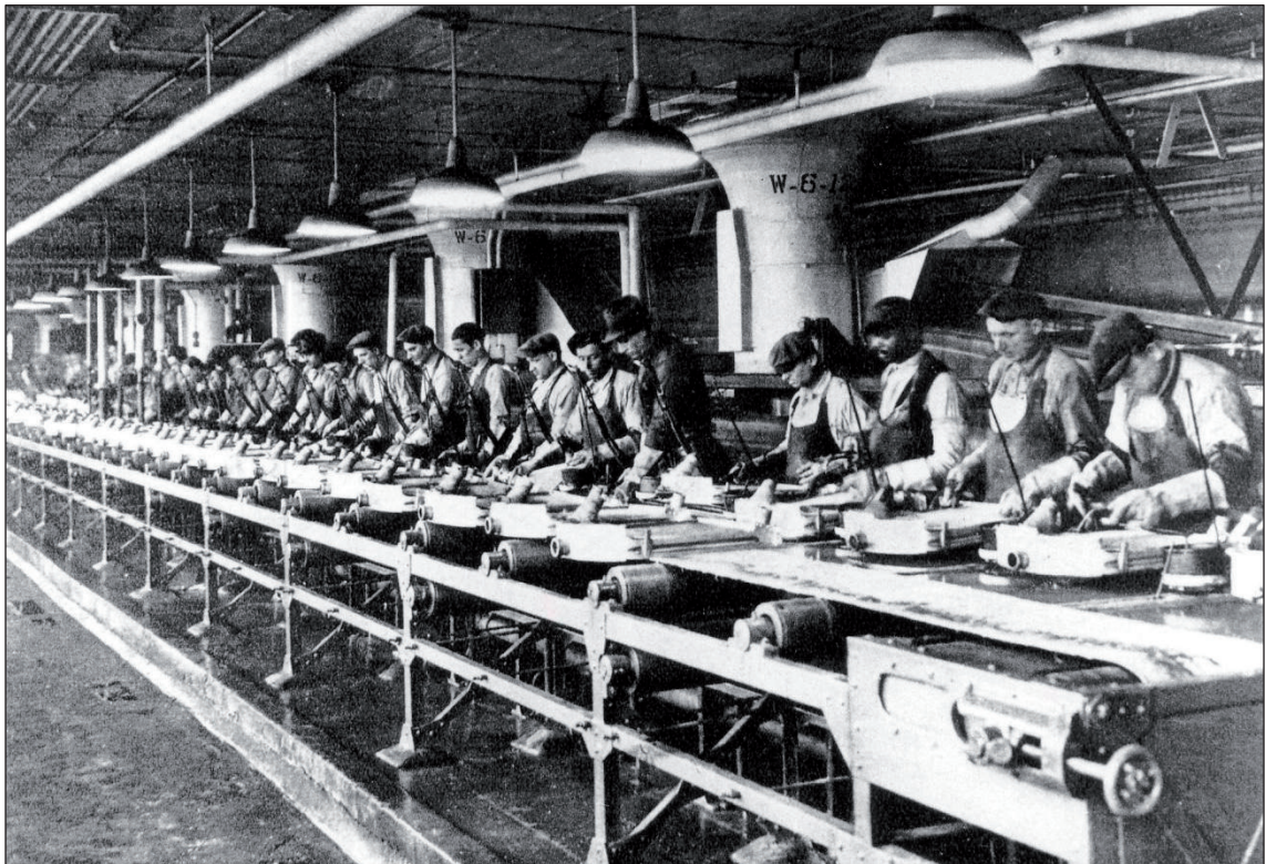
Assemblage van radiatoren bij de Ford Motor Company omstreeks 1918. De snelheid van de lopende band bepaalde het slopende werktempo en het lidmaatschap van een vakbond vond in de ogen van Henry Ford geen genade. (Coll. Auteur).
