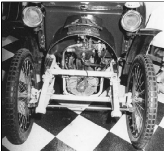
1899 Renault type A Voiturette met een 1 \frac{3}{4} pk De Dion Bouton eencilinder. (foto auteur).
