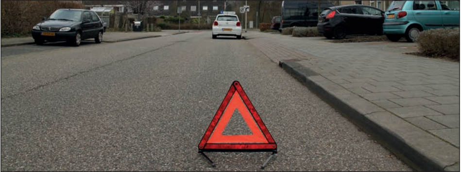
Plaats bij pech de gevarendriehoek op ongeveer 30 meter van het voertuig in de richting van het naderende verkeer.
