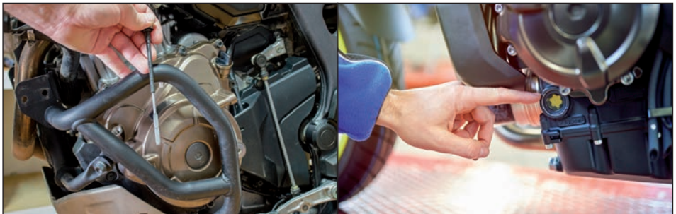
Motorfietsen kunnen voorzien zijn van een oliepeilstokje. Maar veel motorfietsen hebben een oliepeilglasje.
