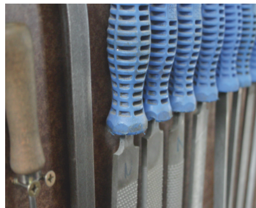
F125: Vijlen moeten voorzien zijn van een stevig heft.
