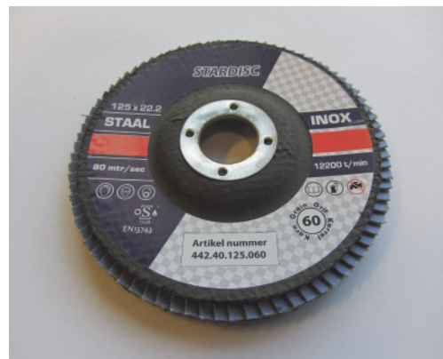
F149: Op de slijpschijf staan alle belangrijke gegevens voor de toepassing vermeld.
