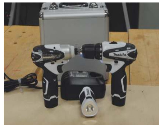
F145: Handgereedschap op accu's is door de lage spanning elektrisch veilig.
