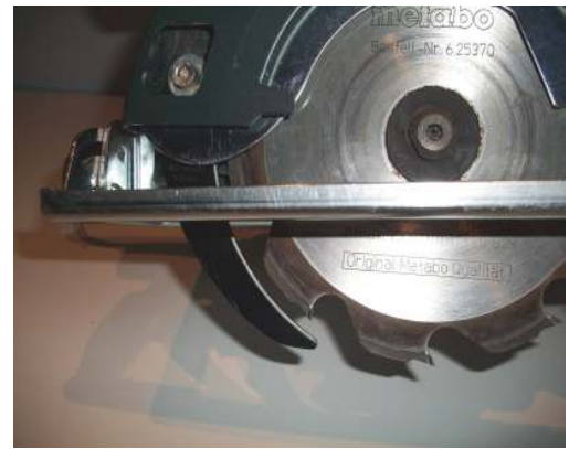
F152: Een cirkelzaag moet uitgerust zijn met een spouwmes.
