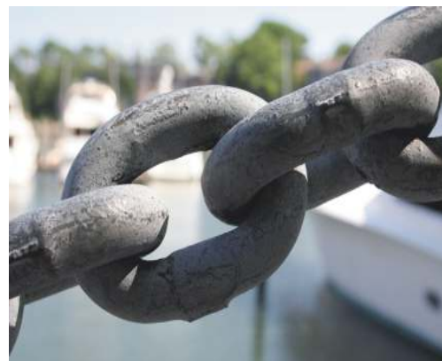
F173 : Kettingen worden gebruikt bij zeer zware lasten.
