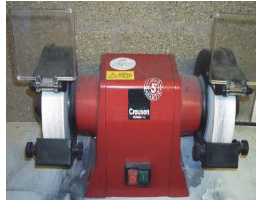
F164: Slijpstenen alleen laten vervangen door deskundig personeel.
