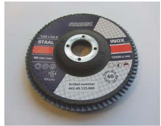
F149: Op de slijpschijf staan alle belangrijke gegevens voor de toepassing vermeld.
