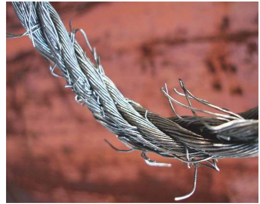
F176 : Staalkabels moeten bij beschadiging worden afgekeurd.
