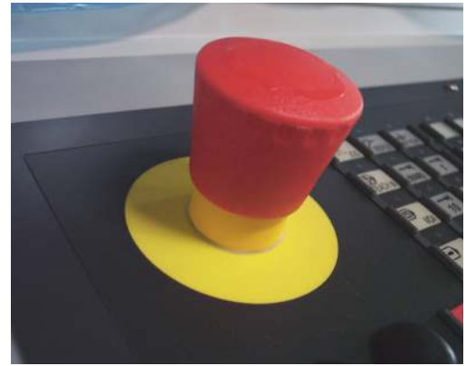
F133: Met de noodstopdrukker kan de machine bij gevaar direct uitgeschakeld worden.
