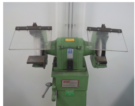
F163: Een slijpmachine moet voorzien zijn van beschermruitjes.
