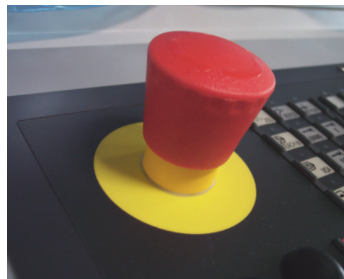
F133: Met de noodstopdrukker kan de machine bij gevaar direct uitgeschakeld worden.
