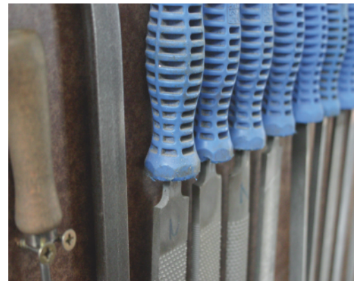
F125: Vijlen moeten voorzien zijn van een stevig heft.
