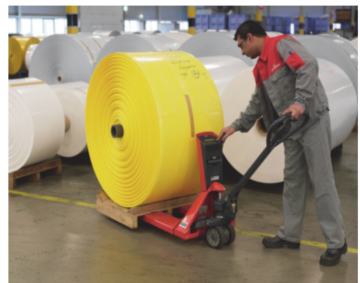
F184: Een palletwagen met weegmogelijkheid.
