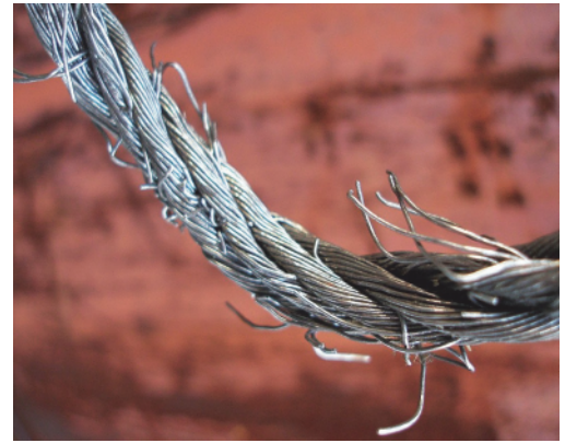
F176 : Staalkabels moeten bij beschadiging worden afgekeurd.
