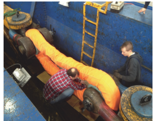
F177: Het beproeven van een hijsband voor zeer zware lasten.
