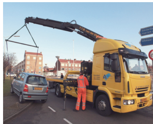
F179 : Gebruik van een hijsjuk voor het hijsen van een auto.
