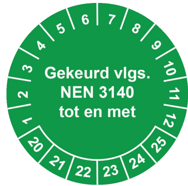
F146: Elektrisch handgereedschap moet elk jaar gekeurd worden.
