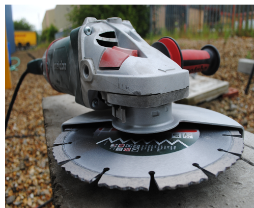
F150: Gebruik een doorslijpschijf niet om af te bramen. explosie veroorzaken.
