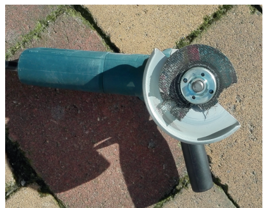
F150: Een slijptol is een voorbeeld van elektrisch handgereedschap. Let op: De schijf kan uit elkaar springen.
