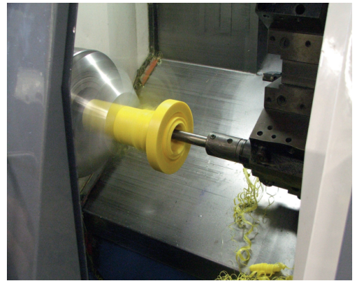
F130: Bij een mechanisch aangedreven machine kun je gegrepen worden door de bewegende delen.
