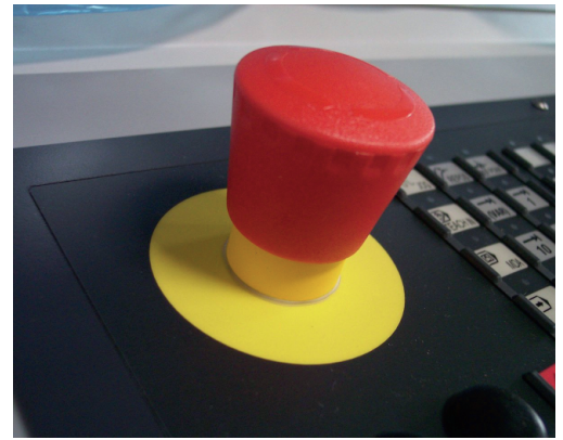
F133: Met de noodstopdrukker kan een vaste machine bij gevaar direct uitgeschakeld worden.
