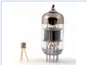
Transistor naast een elektronenbuis.
