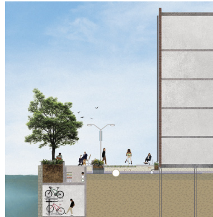
Doorsnede Korte Schimmelstraat. Groen dak, afgekoppelde regenpijp, datakoker in waterbergende groenstrook, groene speelvoortuin, groene strook met regenwaterinfiltratie, zonnepanelen, buurthuis/dansstudio, warmtepomp.
