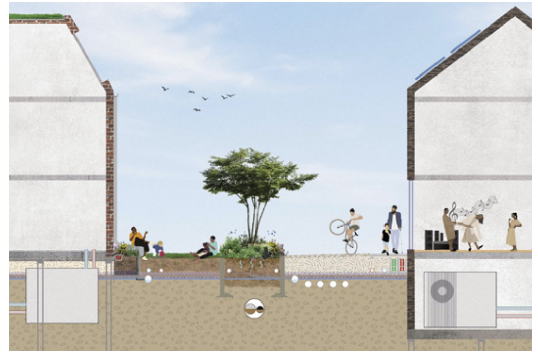
Doorsnede Korte Schimmelstraat. Groen dak, afgekoppelde regenpijp, datakoker in waterbergende groenstrook, groene speelvoortuin, groene strook met regenwaterinfiltratie, zonnepanelen, buurthuis/dansstudio, warmtepomp.
