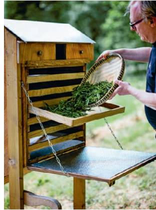
Met de zonneoven worden de theebladeren gefaseerd verwelkt en gedroogd.
