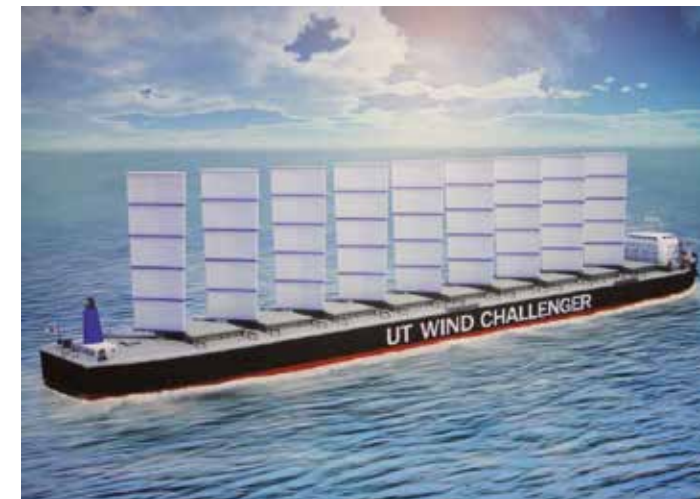
Figuur 1.13 Modern vrachtschip met geautomatiseerde zeilen (Bron: www.wordlesstech.com )
